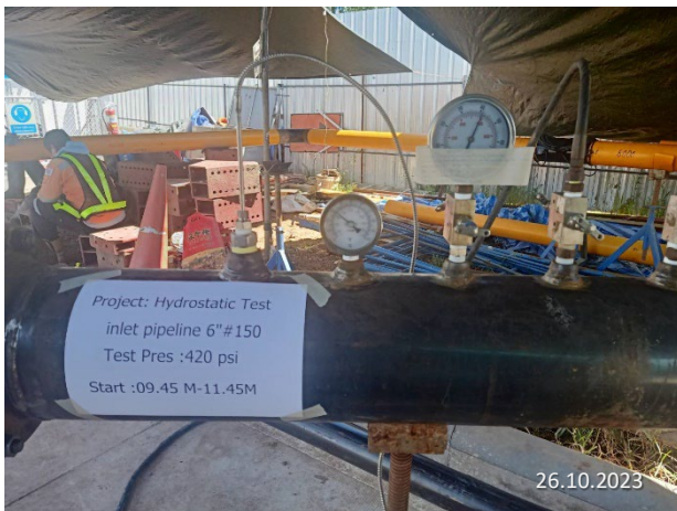
ข) การทดสอบด้วยวิธีทางชลสถิต (Hydrostatic Test)
